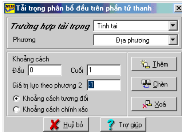
Hình III.18. Tải trọng phân bố đều trên phần tử thanh
