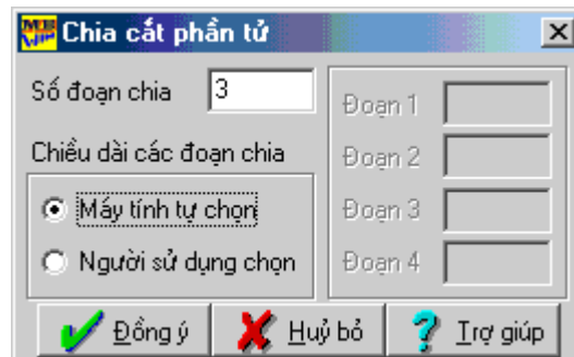
Hình II.5. Chia cắt phần tử thanh
