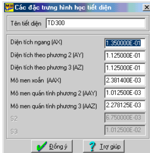
Hình III.6. Đặc trưng hình học của tiết diện
